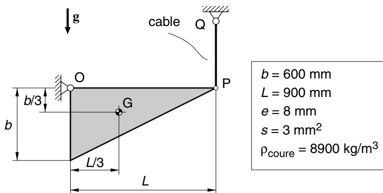
La placa de cobre de la figura de grosor  $e = 8 \text{ mm}$  está articulada en el punto O y se mantiene en reposo mediante el cable PQ de sección nominal  $s = 3 \text{ mm}^2$ . Determine:
