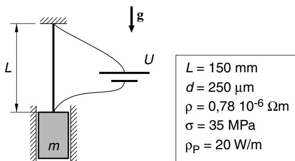
El flexinol es un hilo de nitinol que tiene la propiedad de recuperar el tamaño cuando se calienta si se había deformado plásticamente.
