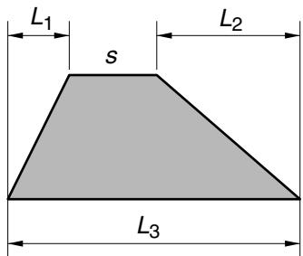
En el plano de una placa se han acotado las medidas  $L_1$ ,  $L_2$  y  $L_3$  y se indica que la tolerancia
