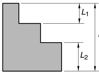
En un plano se han acotado las medidas  $L_1$ ,  $L_2$  y  $L_3$  y se indica que la tolerancia general es  $\pm 50 \mu\text{m}$ . La tolerancia del escalón central es:
