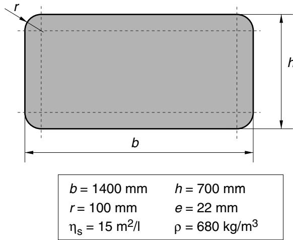
Un carpintero debe cortar el tablero del dibujo con contraplacado de grosor  $e = 22 \text{ mm}$ , aplacar los cantos con una lámina de madera decorativa y darle tres capas de barniz a cada cara. La densidad del contraplacado utilizado es  $\rho = 680 \text{ kg/m}^3$  y el rendimiento del barniz es  $\eta_s = 15 \text{ m}^2/\text{l}$  (con 1 l de barniz puede darse una capa de barniz a una superficie de  $15 \text{ m}^2$ ). Determine:
